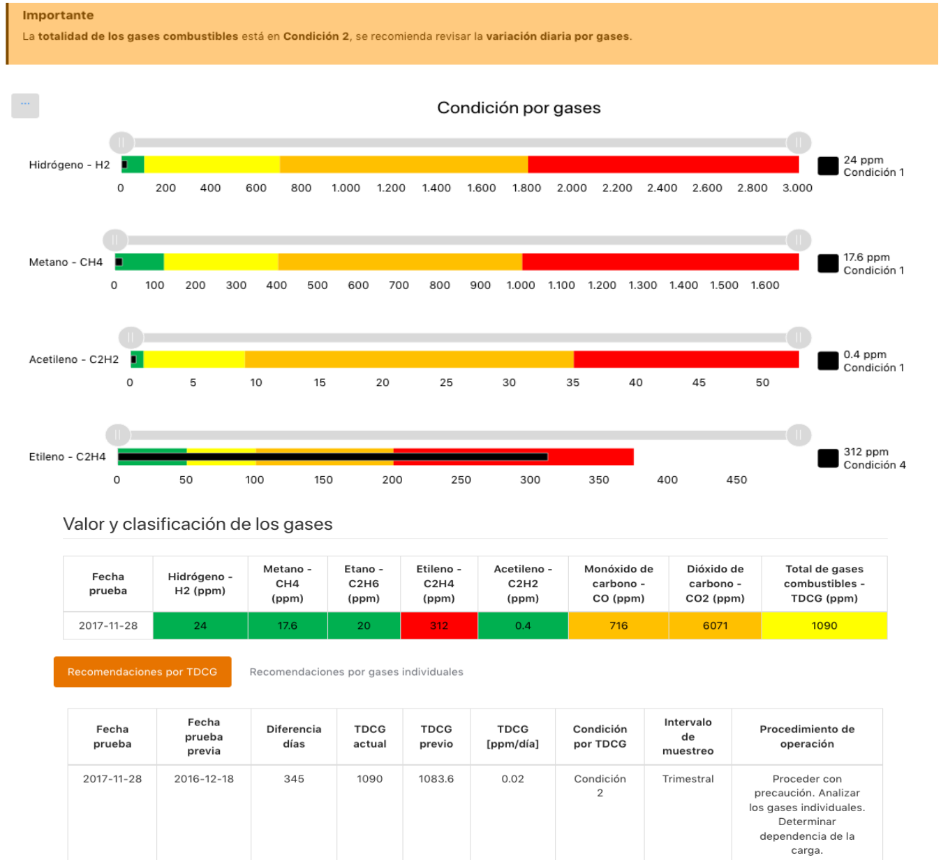
Figura 15. Contenido de cada gas y variación diaria por gases (Clasificación de acuerdo al Std. IEEE C.57.104-2008).
